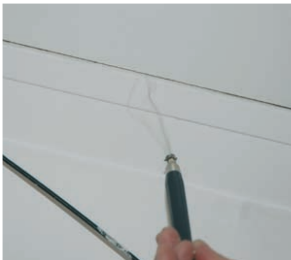
Fot. 3. Nieszczelność we wlocie na poddasze
